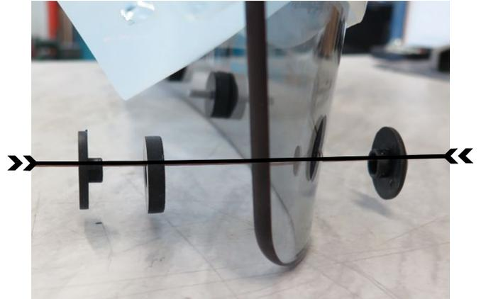
Skruva fast rutan i främre kanten med M5 skruvarna.
