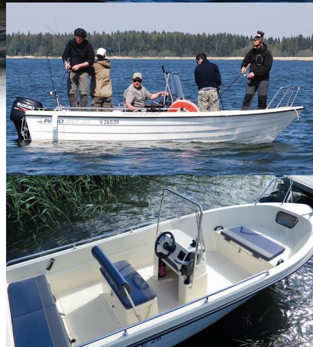
**PARO 520:**stä valmistetaan myös mallia, jossa ohjauspulpetti on edempänä ja varustettu kahden hengen selkänojallisella penkillä. Penki toimii säilytytilana ja selkänoja voidaan kääntää eteenpäin. Tyynyt kuuluvat toimitukseen tässä versiossa.
