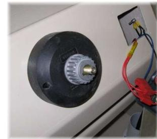
Reglaget skall monteras så att spaken inte tar i vindrutan vid full gas
